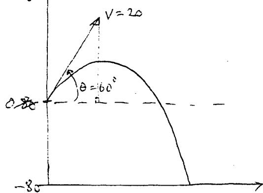
$$t=0 \quad V=20 \quad \theta=60^\circ \quad g=10, x=0, y=0,$$
